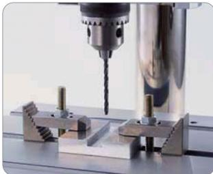
付属のドリルチャックを取り付けて穴開け加工もできます。
