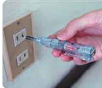
通電していればLEDが点灯します
