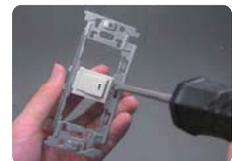
D-655-100は連用取付け枠の操作がしやすい刃幅5.5mmのドライバーです。
